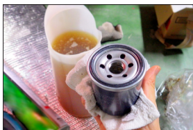
■オイルエレメント交換
